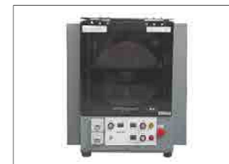
大手企業からの問い合わせが増えている粉砕、混練用途の3次元ボールミル
